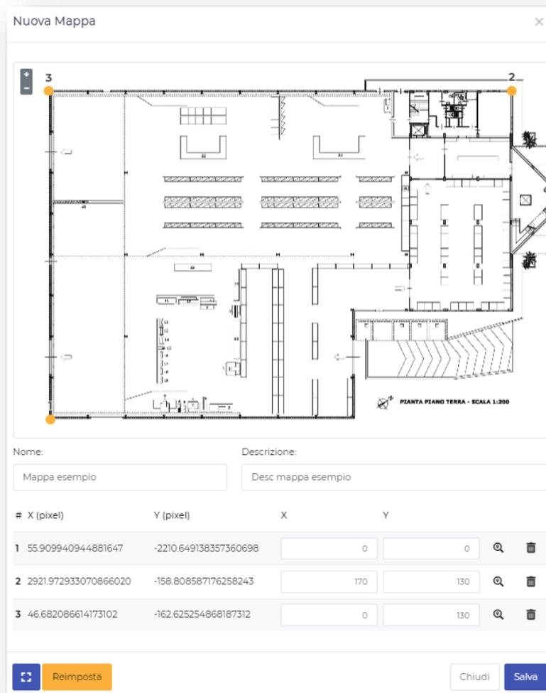
Fig. 50 - Pannello Nuova mappa - Esempio di definizione dei vertici dell'impianto e relative coordinate cartesiane
